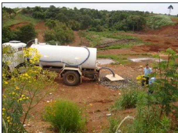
**Figura 95: Caminhão Limpa-Fossa Despejando seu Efluente no Sistema de Tratamento do Aterro Sanitário (Foto: Arquivo SANEFRAI).**
