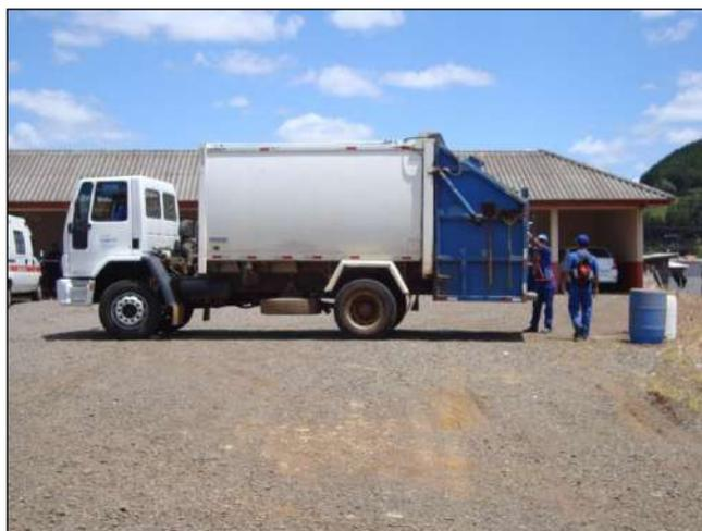
**Figura 79: Caminhão Compactador que Realiza a Coleta Domiciliar Convencional.**
