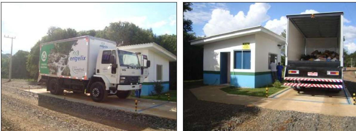
**Figura 83: Balança Rodoviária para Pesagem dos Caminhões Coletores (Foto: Março/2012).**
